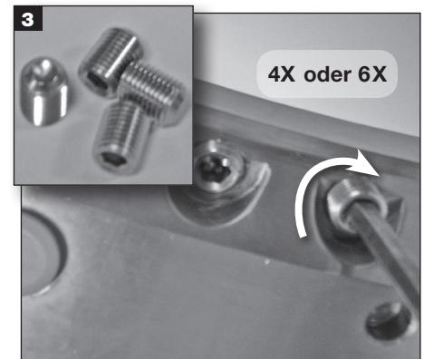
3 Neue Ringschneide-Einstellschrauben schmieren und in den Gegenringhalter (rotierend) einbauen.
