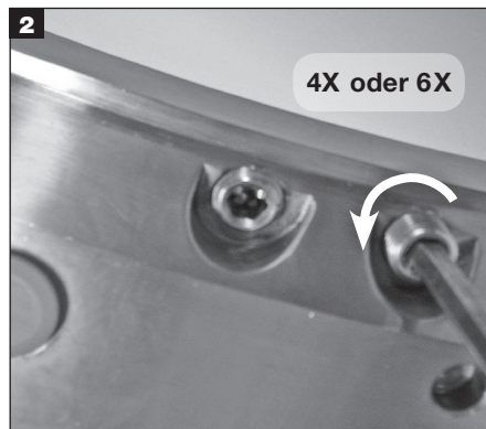
2 Die alten Ringschneide-Einstellschrauben aus dem Gegenringhalter (rotierend) entfernen.
